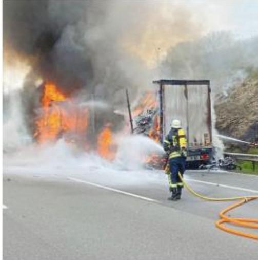
Durch den Brand kommt es zu einer Kettenreaktion bei den überhitzten Lithium-Ionen-Akkus: Die Zellen öffnen sich explosionsartig, ihre Bestandteile fliegen durch die Luft. Foto: Feuerwehr Vlotho
