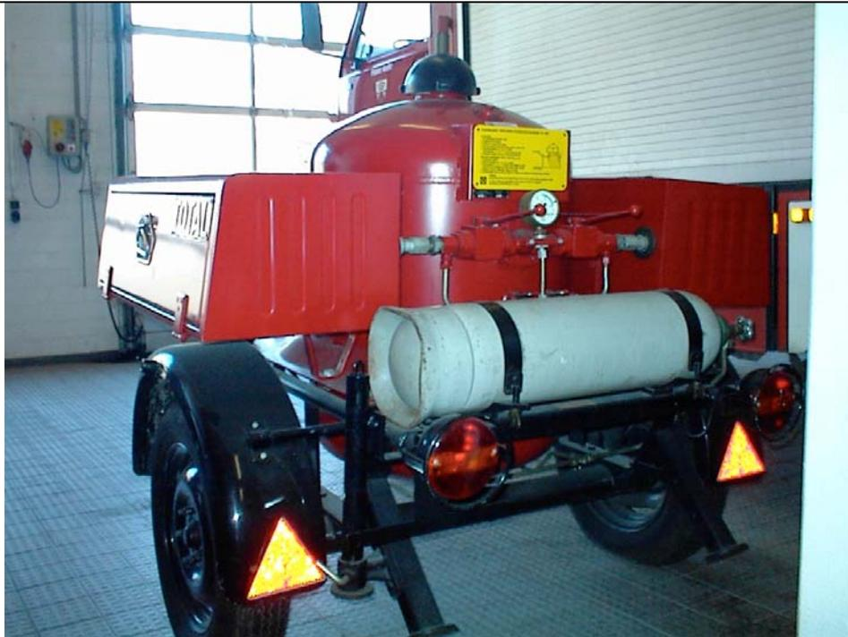
**Pulverlöscher 250 kg P 250 Standort Löschzug Vlotho**
